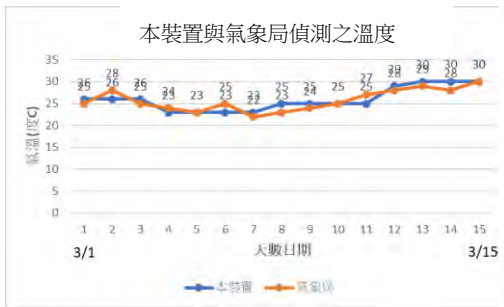
圖(八十八)本裝置溫度準確性比較折線圖 圖(八十九)本裝置照度準確性比較折線圖
