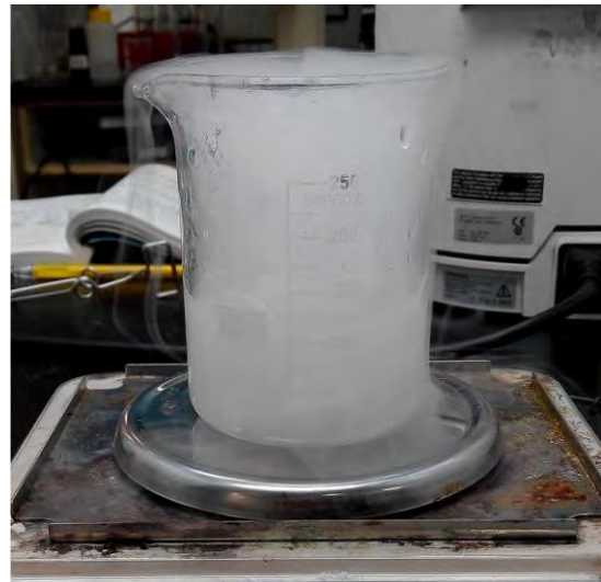
乾冰在乙二醇中白煙的生成情形
