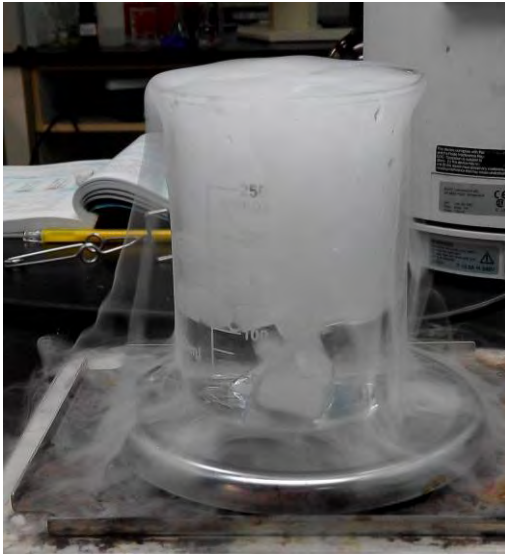
乾冰在水中白煙的生成情形
