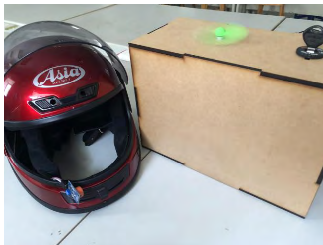
圖（二十七）以風扇表示機車電源，此時電源因為基準值未超標而不會被切斷。
