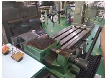
圖5-2 敲擊並鎖緊使燈亮平行
