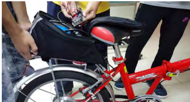
圖 18 模擬不同自行車爬坡不同角度並對應轉速輸出電壓變化
