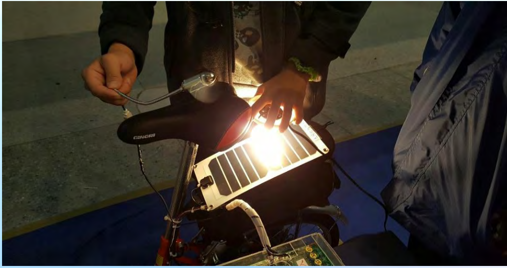
圖 4 太陽能板受到燈泡光源照射
