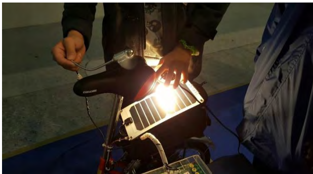
圖 26 光源照射產生 6V 電壓
