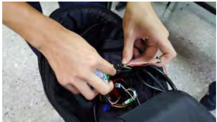
圖 14 安裝電動助行車之馬達調速輸入信號線
