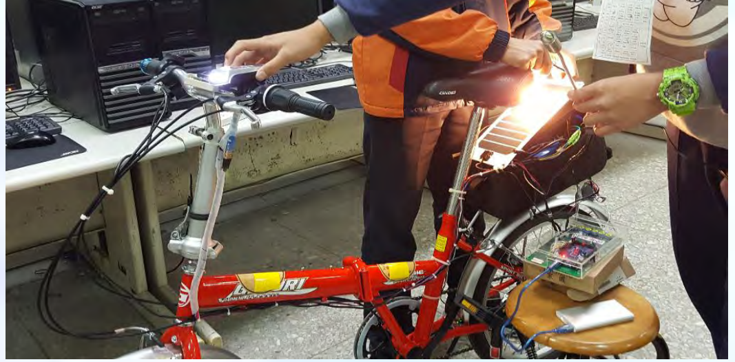
圖 5 太陽能板供應電動自行車頭燈及電風扇
