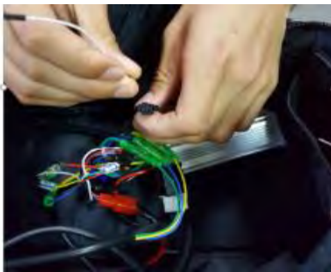
圖 14 安裝電動助行車之馬達調速輸入信號線
