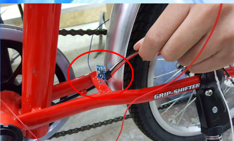
圖 2 製作硬體電路與角度感測器安裝
