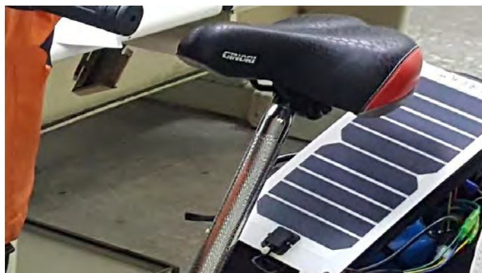
圖 4 本作品使用薄膜型太陽能電池以減輕電動助行車之重量
