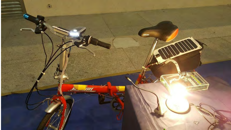
圖 32 太陽能光電板結合電動助行車
