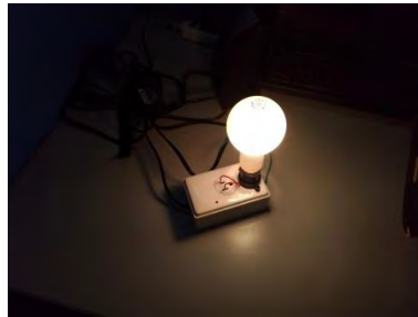
圖12 使用電力插座量測電器
