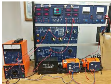
圖13 使用電機機械實驗設備量測電器
