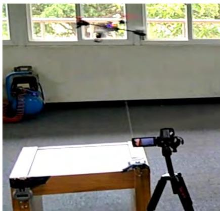
圖 5、遙控無人機並以錄影機紀錄電子彈簧秤上的數據實驗圖
