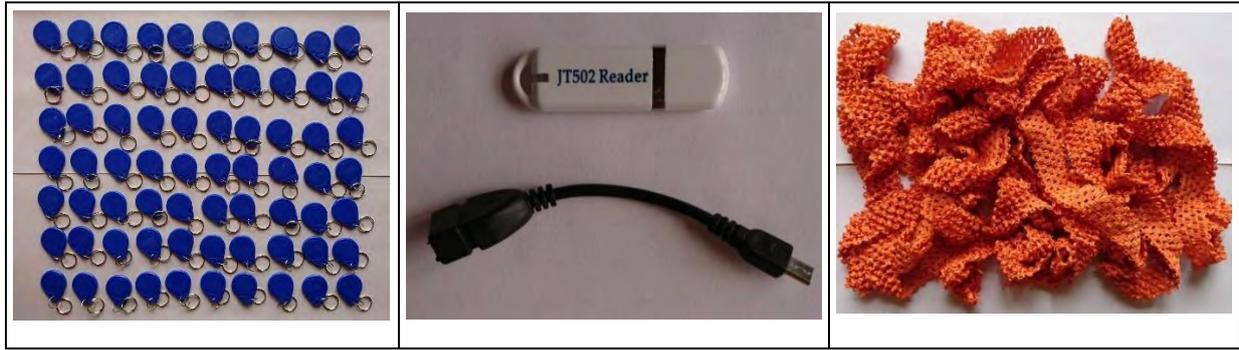
圖 3. RFID 磁扣、USB 連接器及讀寫器、固定之彈力繩
