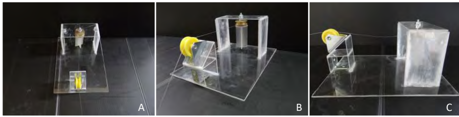
圖七、黏度測試裝置圖。A、B、C 為不同角度拍攝
