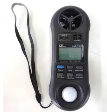
圖十六、扇葉型風速計
