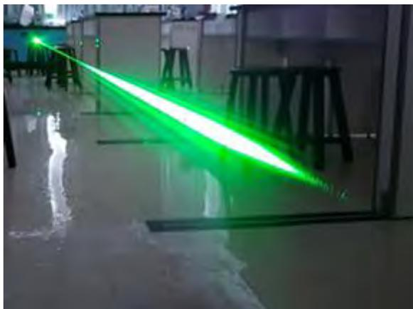
圖一:細線繞射時的光束圖，我們利用噴霧器將水噴灑至空中，藉以利用單眼相機拍攝下光徑。
