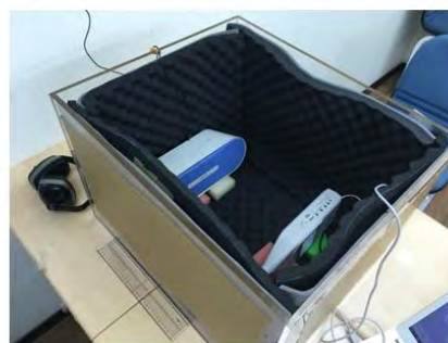
黏貼材料(波浪泡棉)後
