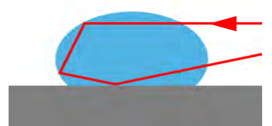
圖24 雷射光射入水滴示意圖
