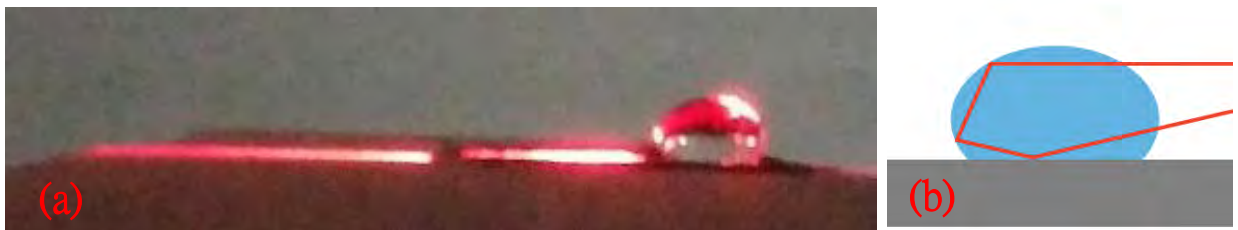
圖38 (a)水滴於碳黑砂紙之反射情形側視圖 (b)雷射光反射示意圖
