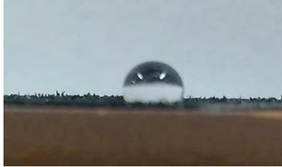
圖11 炭粉載體上的接觸角
