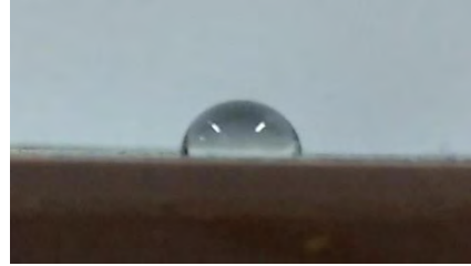
圖12 6B鉛筆載體上的接觸角
