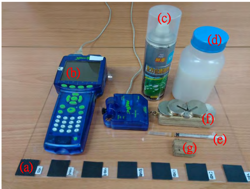
圖3 實驗器材 (a)砂紙 (b)數位量測主機與力感測器 (c) 防水噴劑 (d) 氟素 (e)空針 (f)大木塊 (g)小木塊(h) 碳粉 (i) 蠟燭
