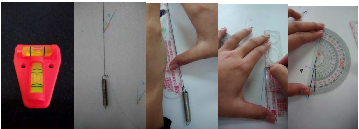
圖 22 水平儀放置 圖 23 吊掛鉛垂線 圖 24 畫上鉛垂線 圖 25 標示落點 圖 26 測量偏轉角( \phi )
