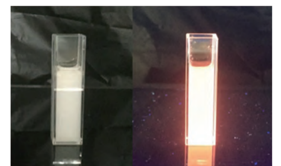
圖五 用甲苯為溶劑配置出的AuNCs
