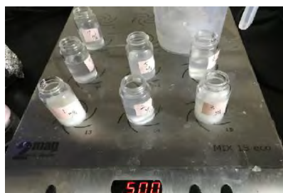
圖十五 不同條件下製備過程 (金離子濃度、酸鹼度、溫度)
