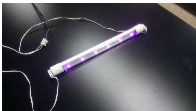
圖三 波長 380-400nm 紫外線 LED 燈
