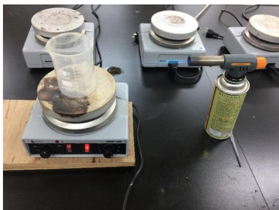
圖 18. 以特製的磁石攪拌器搭配噴槍使燒杯穩定加熱
