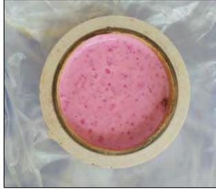
雙面膠框脫模後，雙面膠框內側紙面被破壞，只能單次使用。
