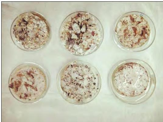
▲實驗過程中，我們做了一套粗顆粒的吸水材，但是在固化 72 小時脫膜時，低估這批吸水材需要更長的乾燥時間，所以我們重做一次，並且再做一套細顆粒的吸水材，為此次的實驗。
