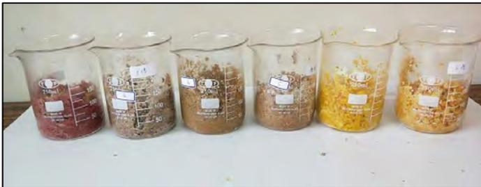
1 將果皮種類加入果膠溶液，置於盆栽中形成吸水土。
