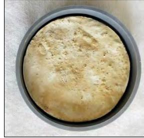
水管截面積，脫模時容易受力不均，造成吸水材碎裂。
