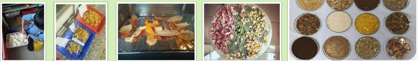
1 浸泡Na<sub>2</sub>S<sub>2</sub>O<sub>3</sub> 2 曬乾72小時 3 烤箱烘烤 4 果皮烘乾機 5 研磨機磨粉
