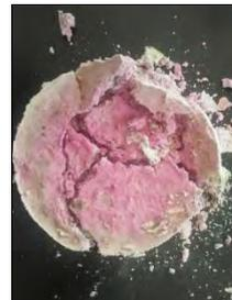
7 第一次製作失敗，因為注模時沒有均勻，導致測第一次吸水率之後就碎裂了。
