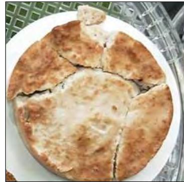
脫模而碎裂的吸水材
