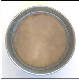
烘培的金屬膜，吸水材脫模不易，容易受力不均，造成碎裂。
