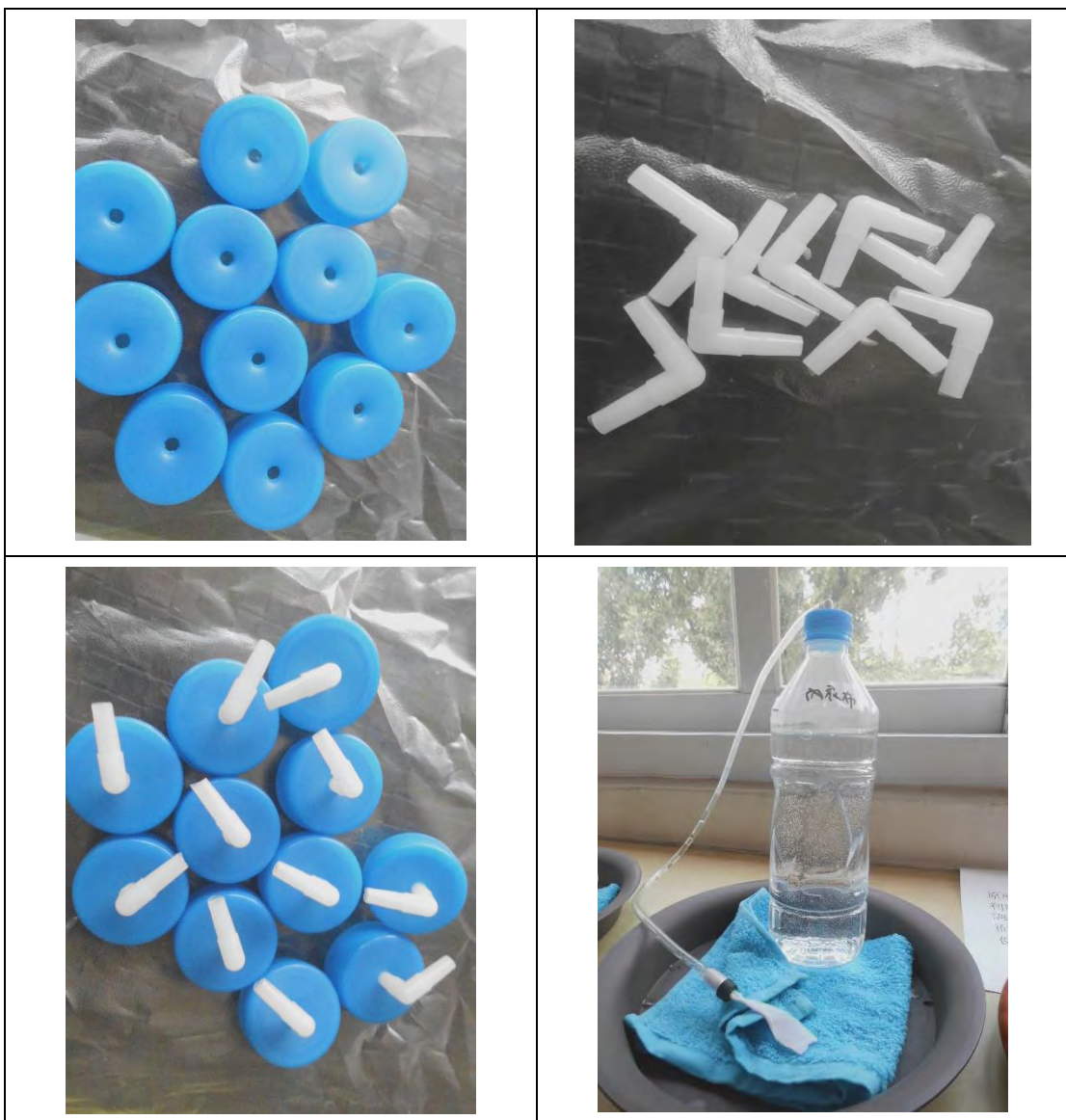
圖 5：寶特瓶瓶蓋鑽孔（左上）、L 型管（右上），與通氣管、氣閥組裝
