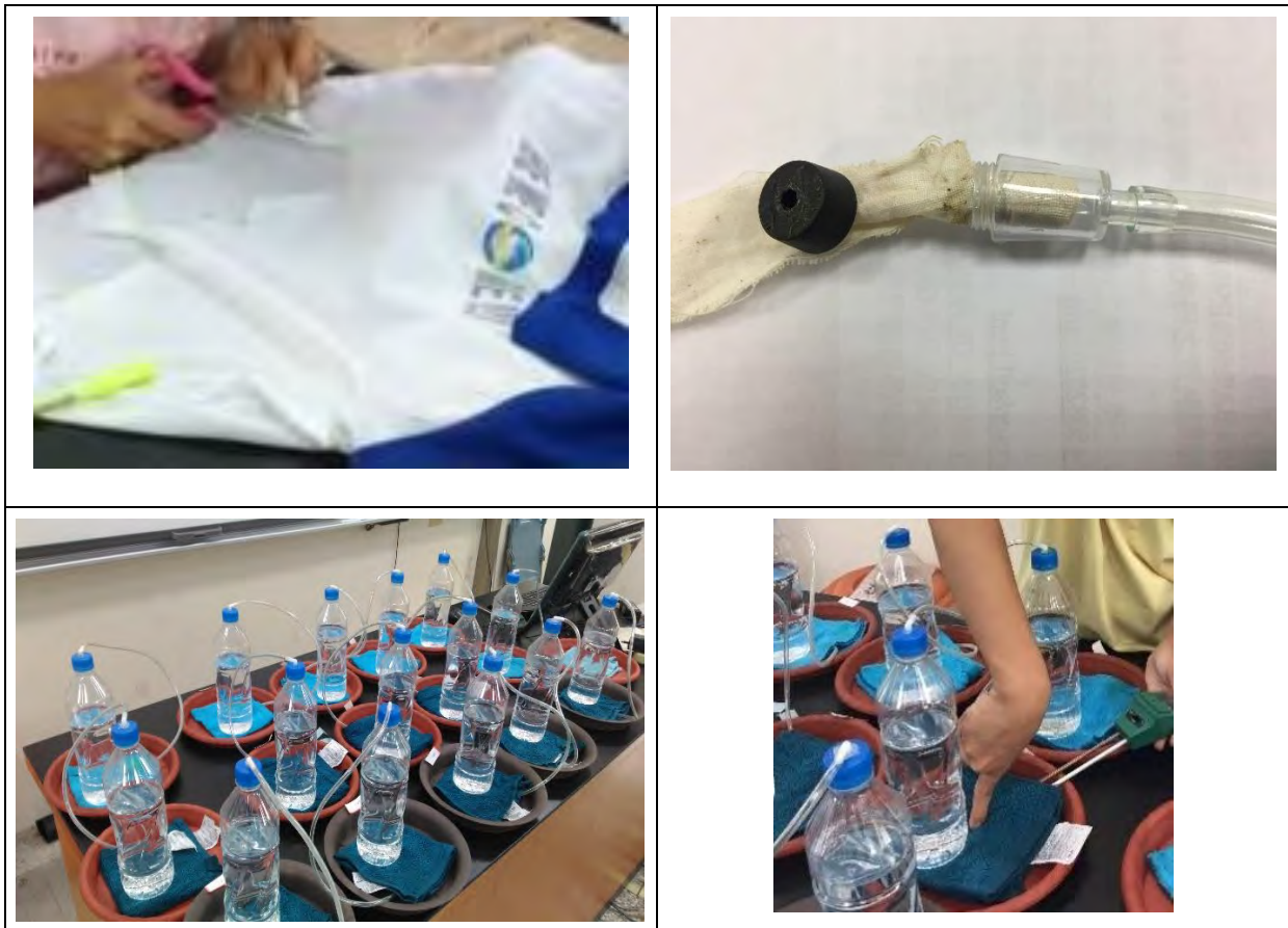
圖 9：剪不同的布塞入氣閥，設置十五組，觀察三個星期
