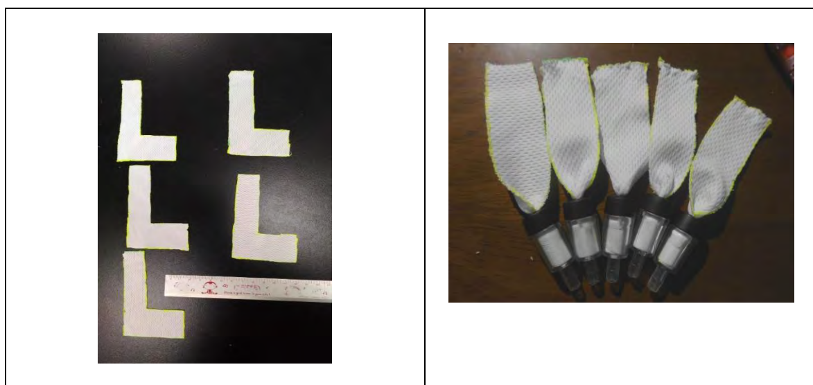
圖 18：將填充物裁剪成一特定形狀塞入氣閥，並留下一端拉出與外界接觸
