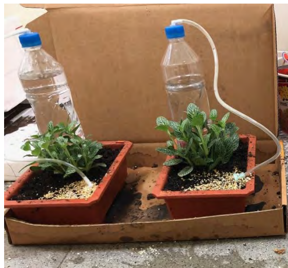
圖 16：利用 3D 列印自製氣閥測土壤濕度
