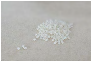
圖(九) SGA0-5:0 之 海藻酸鈉幾丁聚醣膠球複合物
