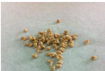
圖(十一) SGA2-5:4 之 海藻酸鈉幾丁聚醣膠球複合物
