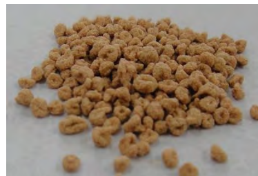
圖(十二) SGA3-5:6 之 海藻酸鈉幾丁聚醣膠球複合物
