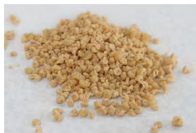
圖(十) SGA1-5:2 之 海藻酸鈉幾丁聚醣膠球複合物
