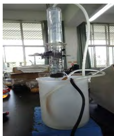
圖(十八)循環水系統示意圖
