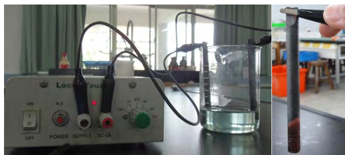
圖(三十四) 回收硫酸銅溶液電解實驗
