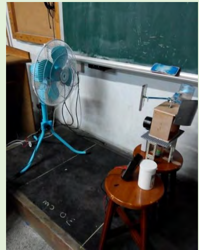
圖 17、測試最低啟動風速
