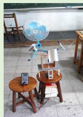
圖 22、傾斜角 45 度阻力型扇葉
