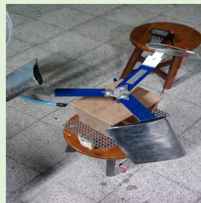
圖 20、傾斜角 45 度升力型扇葉
