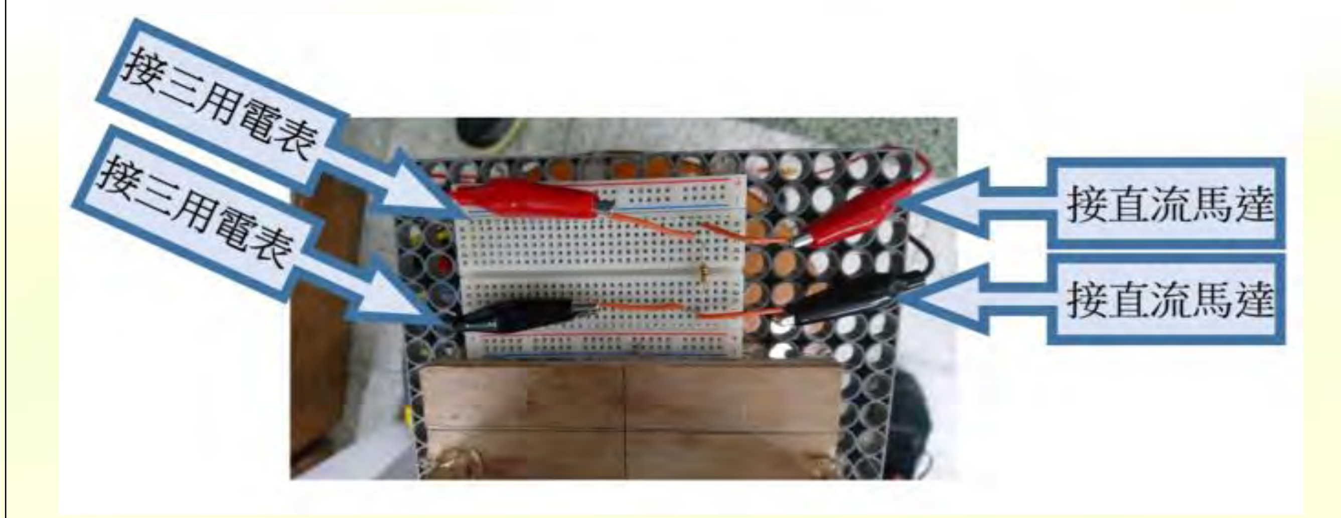
電壓測量方式(並聯)
