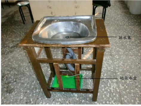
圖12 測量水流自淨能力的裝置
