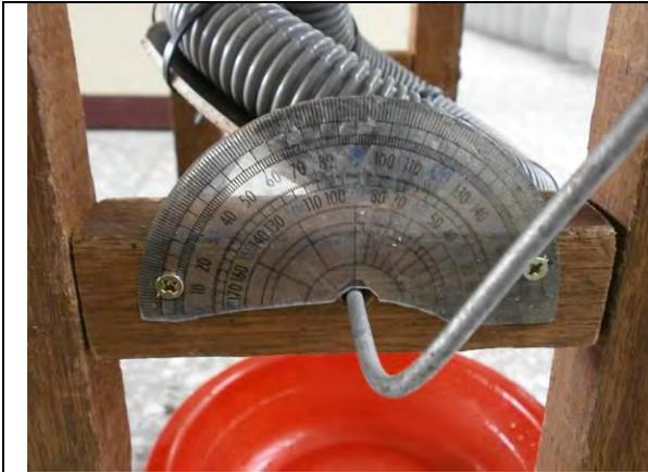
圖 5-1 轉盤與地面夾角角度的設定
