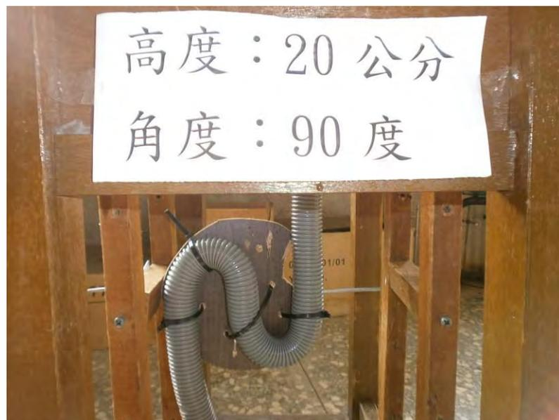
圖 6 本研究實驗對照組：傳統 S 型存水彎 (與地面夾角 90 度)
