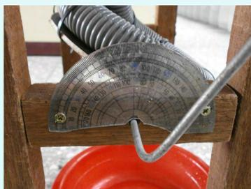
圖4 旋轉盤角度的設定
