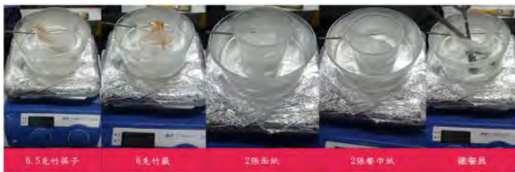
圖 20 一般民眾使用及食用的用品所含鈉鹽檢測之前處理
