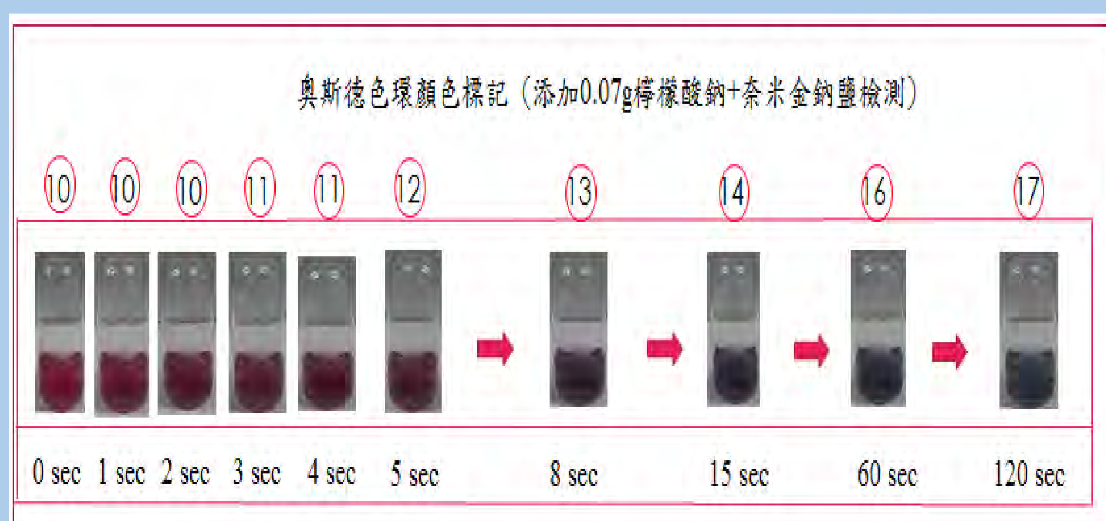
圖 3 奈米金檢測的顏色變化，經奧斯德色環來標註各顏色的顏色系數
