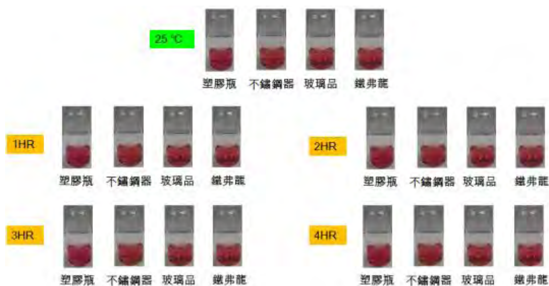
圖 35 奈米金之可靠性測試(儲存容器)
