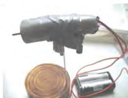
軟管包裹小馬達、可變電阻再接電池盒為電能來源
