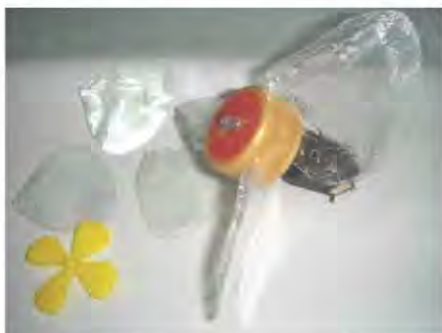
馬達扇葉及已自製好的小型風扇模型
