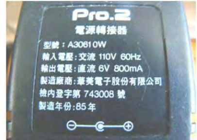
回收手機的變壓器
