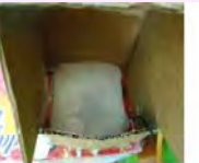
氣流出口加濾網避免污染物流出
