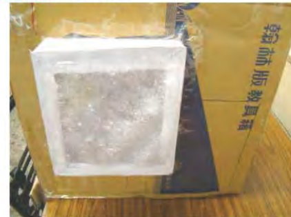
濾網直接在箱外易拆換
