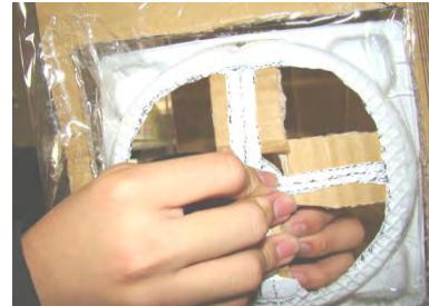
補強支撐風扇及馬達支架
