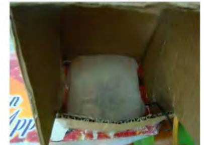
氣流出口加濾網避免污染物流出
