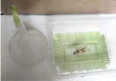
以束口帶固定自製小鋁箔湯匙黏貼於載玻片上(小型硫粉燃燒匙座 A) 的回收塑膠盒內，倒蓋的漏斗口上放置半片沾水的廣用試紙
