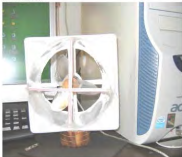
自製 USB 輕型濾風扇接在電腦 主機前方插孔中
