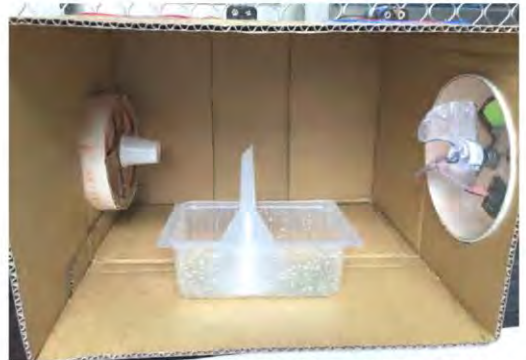
硫粉燃燒實驗在抽排氣箱內進行，可避免實驗時吸入惡臭且具腐蝕性的 \text{SO}_2 氣體(為清楚拍攝畫面，抽排氣箱尚未加外膠門)
