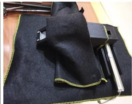
第三代：利用卡榫概念，設計可變更角度和光徑長零件，同時將燈源開三個洞，光源方向與狹縫-光柵方向垂直者為螢光（兩個），平行者為可見光（一個），並因應 UV 燈變更固定方式。
