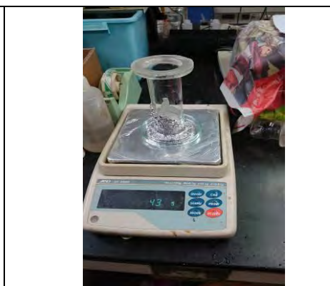
圖 15 加入鋁箔方便固定土壤
