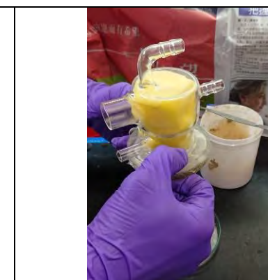
圖 17 加上 silicone 及石臘膜
