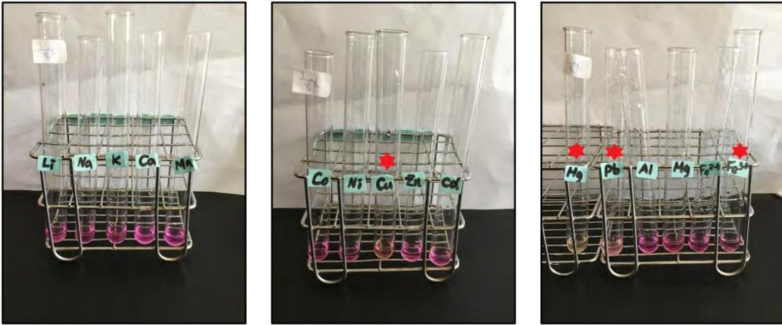
圖 3-3 1mL 稀釋 8 倍火龍果皮萃取液+各式  $10^{-2}M$  金屬溶液 20 滴
