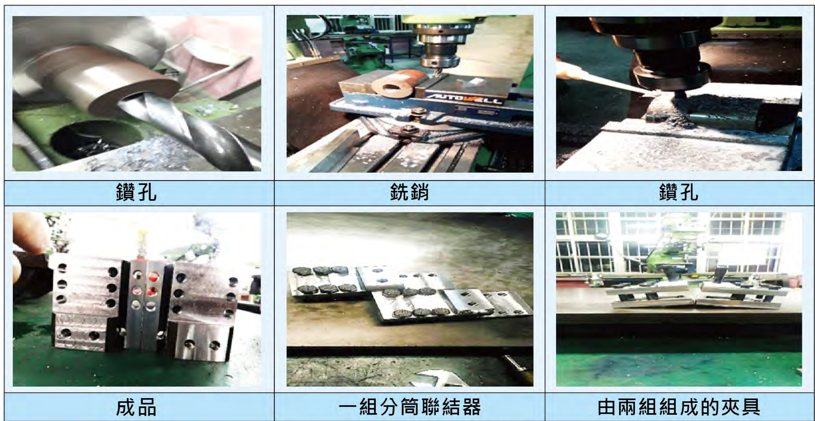
▲圖16、夾具(分筒聯結器)製作過程
