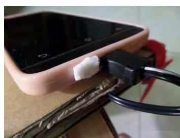
圖 45 麥克風放置海綿降低靈敏度
