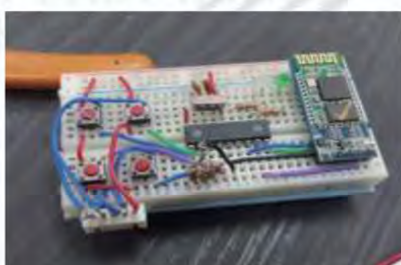
麵包板完成零件安裝與配線
