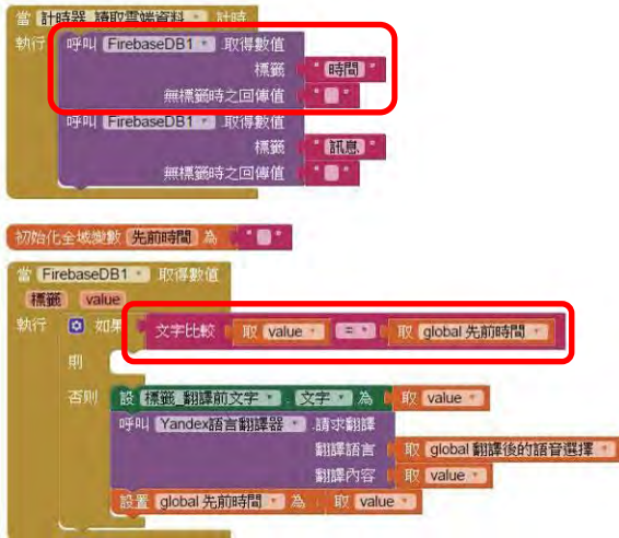
圖 39 接收雲端資料程式新增下載”時間”指令，並修正原訊息比對法更改時間方式
