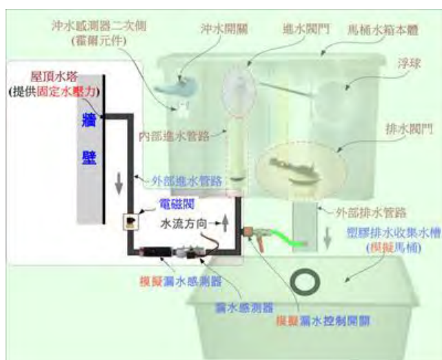
圖 11 (a)從供水源到馬桶水箱之間的设计概念圖 圖 11 (b)完成後的作品實體雛型外觀照片
