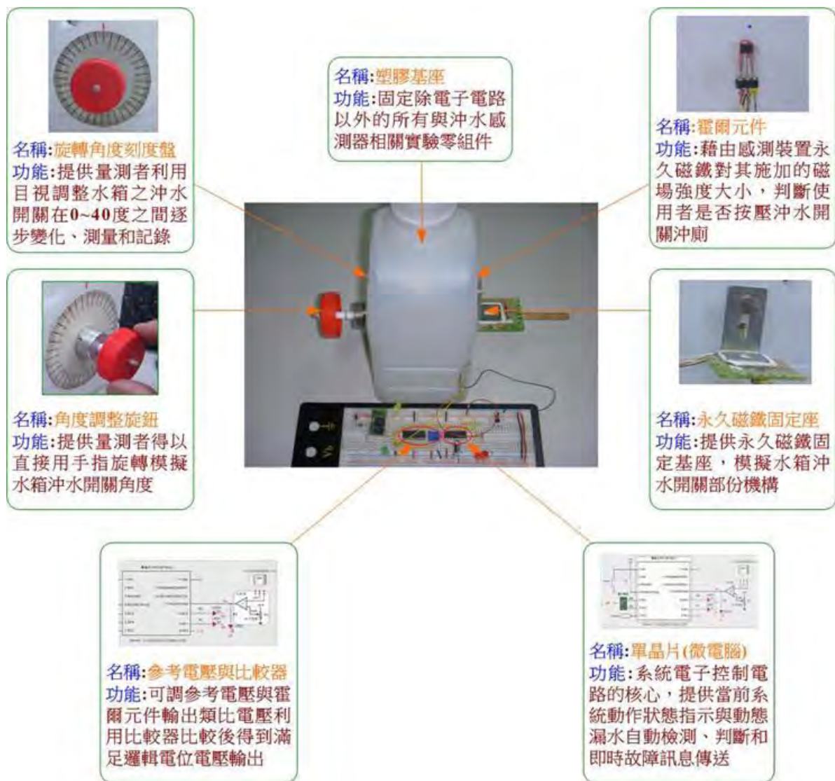
圖23 模仿一般座式馬桶沖水開關周邊機構的沖水感測器實驗模型
