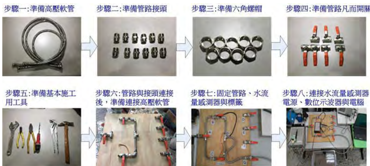
圖8 自製馬桶供、排水管路機構的實驗模型製作過程
