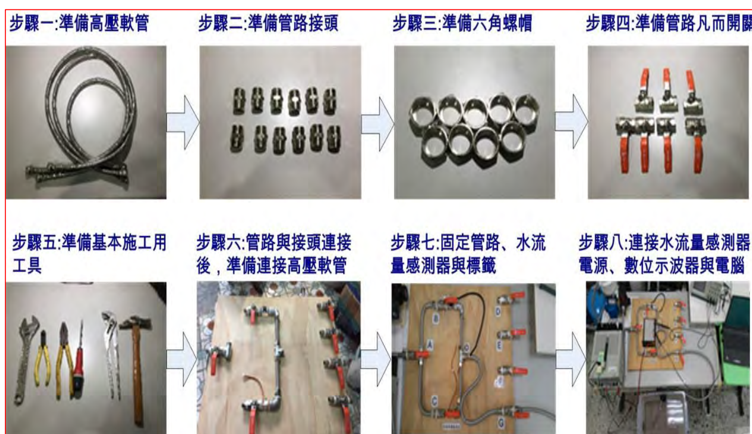
自製馬桶供、排水管路機構實驗模型的製作過程
