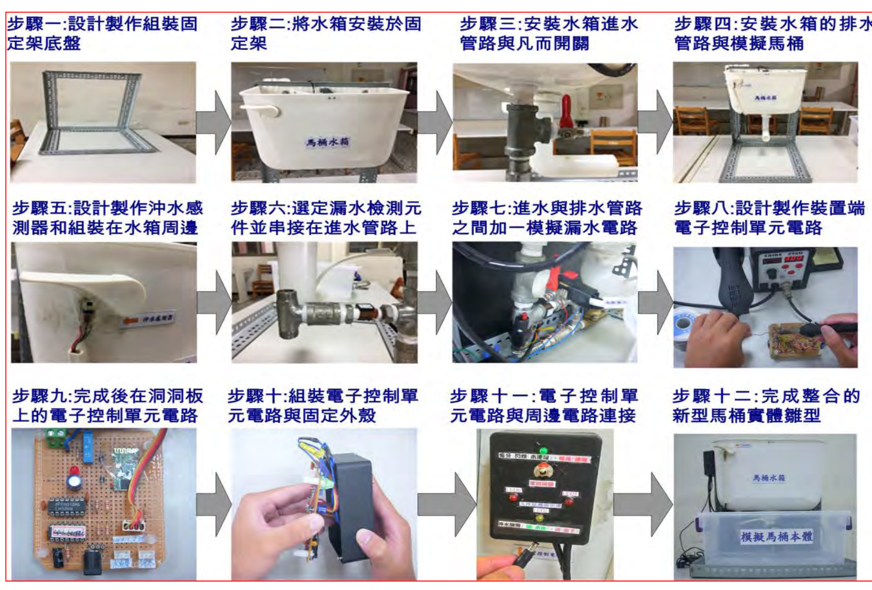
馬桶機構與電子控制電路實體雛型的組裝和整合過程
