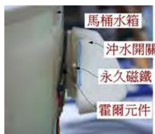
圖 10 (b)選定且裝置在本作品實體雛型上的沖水感測器外觀照片
