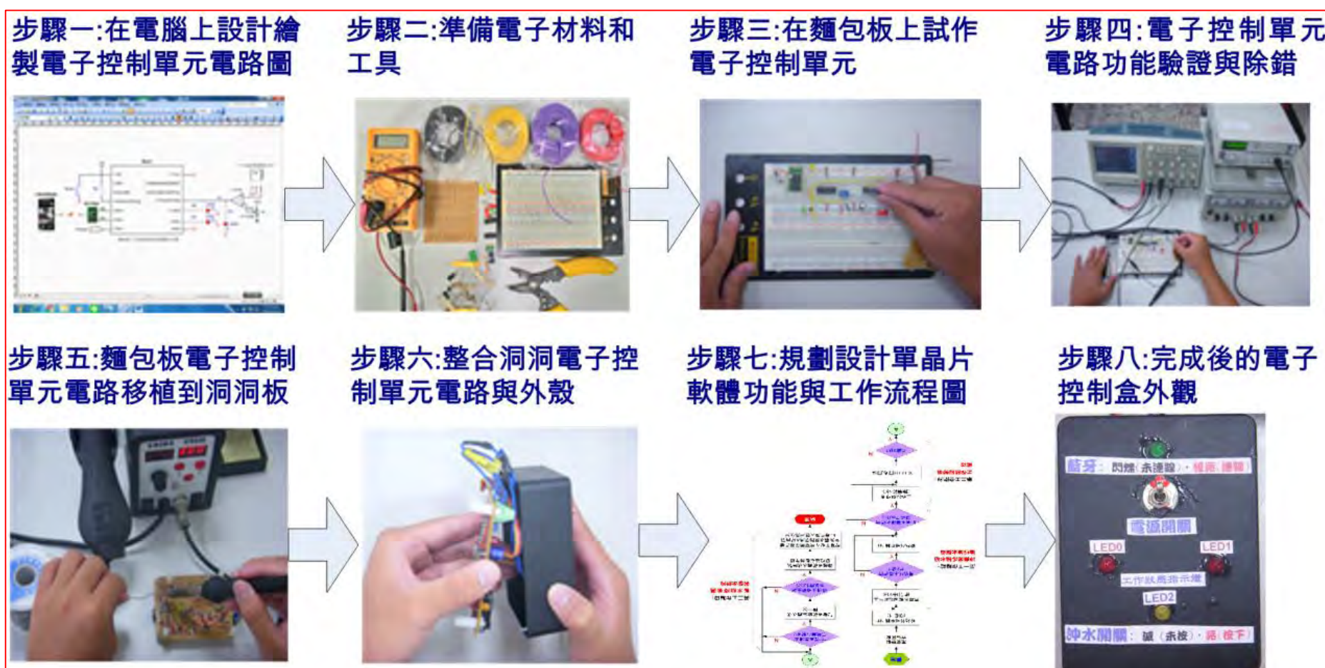
裝置端電子控制電路實體雛型的製作過程
