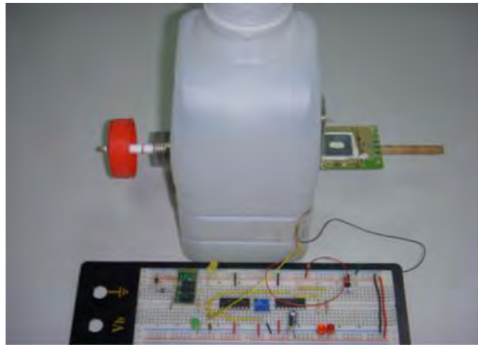
圖 3 模仿座式馬桶沖水開關周邊機構，自製提供選擇最佳沖水感測器元件的實驗模型
