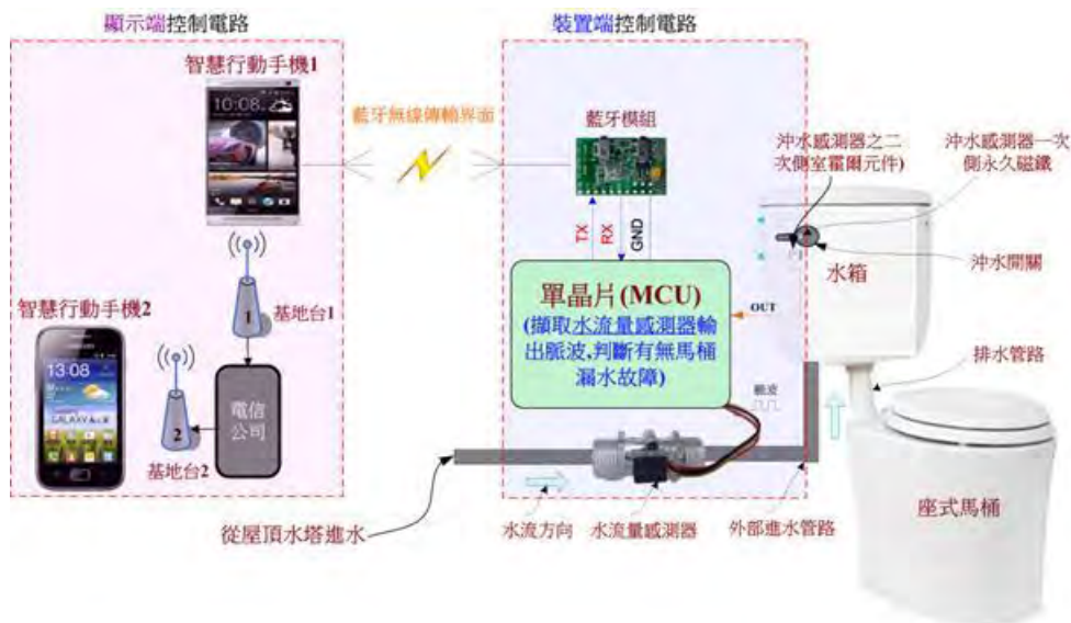
圖7 電子控制電路實體雛型的設計概念圖
