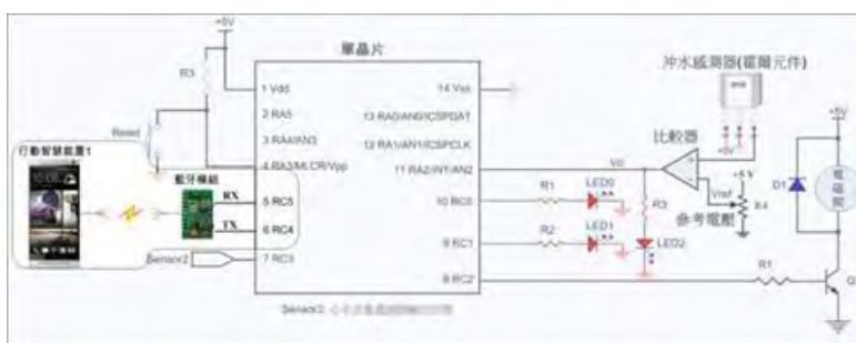
圖28 (a)包含藍牙模組之裝置端設計概念圖
