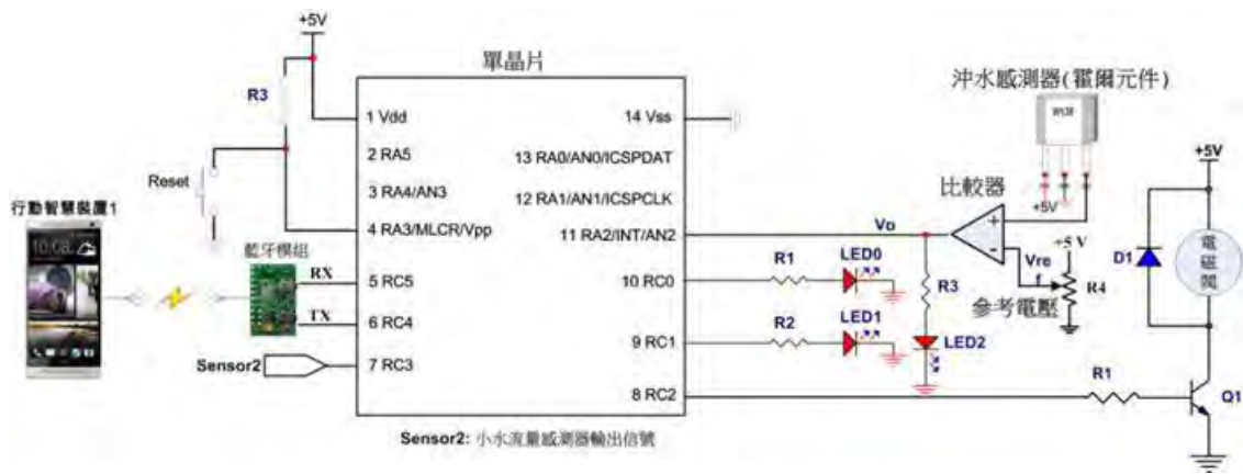
圖 12 裝置端電子控制電路的設計概念圖
