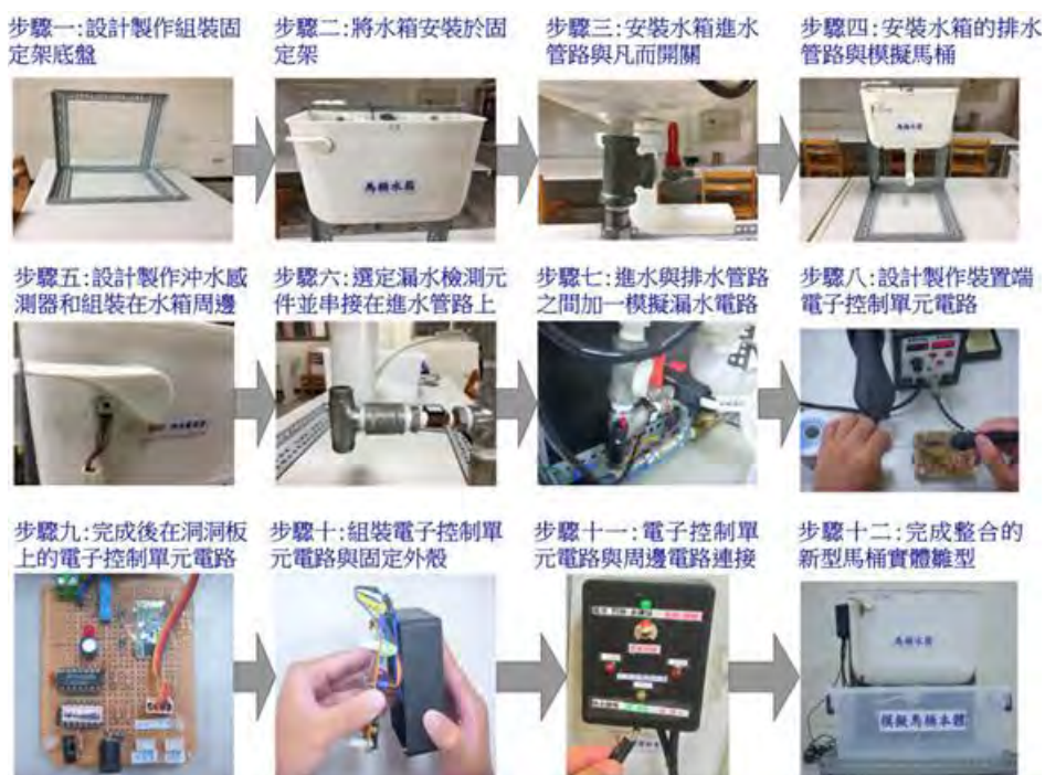
圖 18 馬桶機構與電子控制電路實體雛型的整合組裝過程
