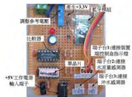
圖28 (b)完成後裝置端控制電路外觀照片
