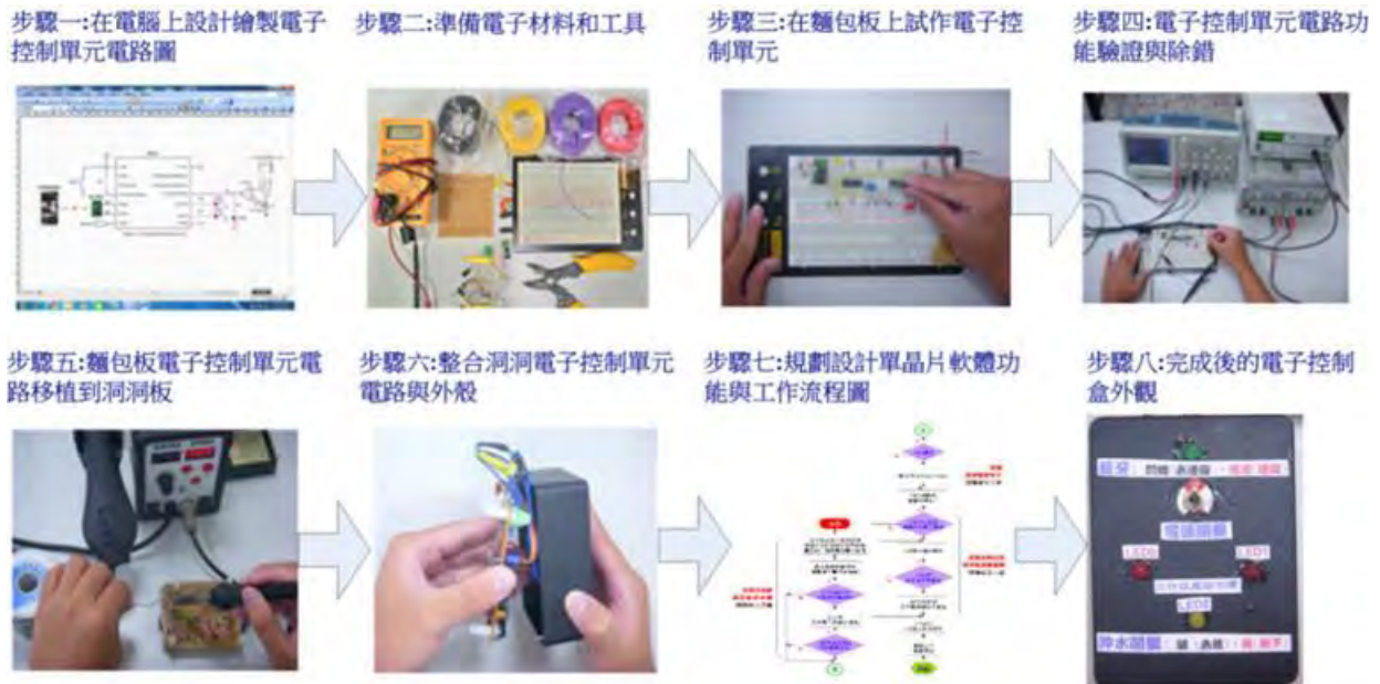
圖 13 裝置端電子控制電路(盒)實體雛型的製作過程
