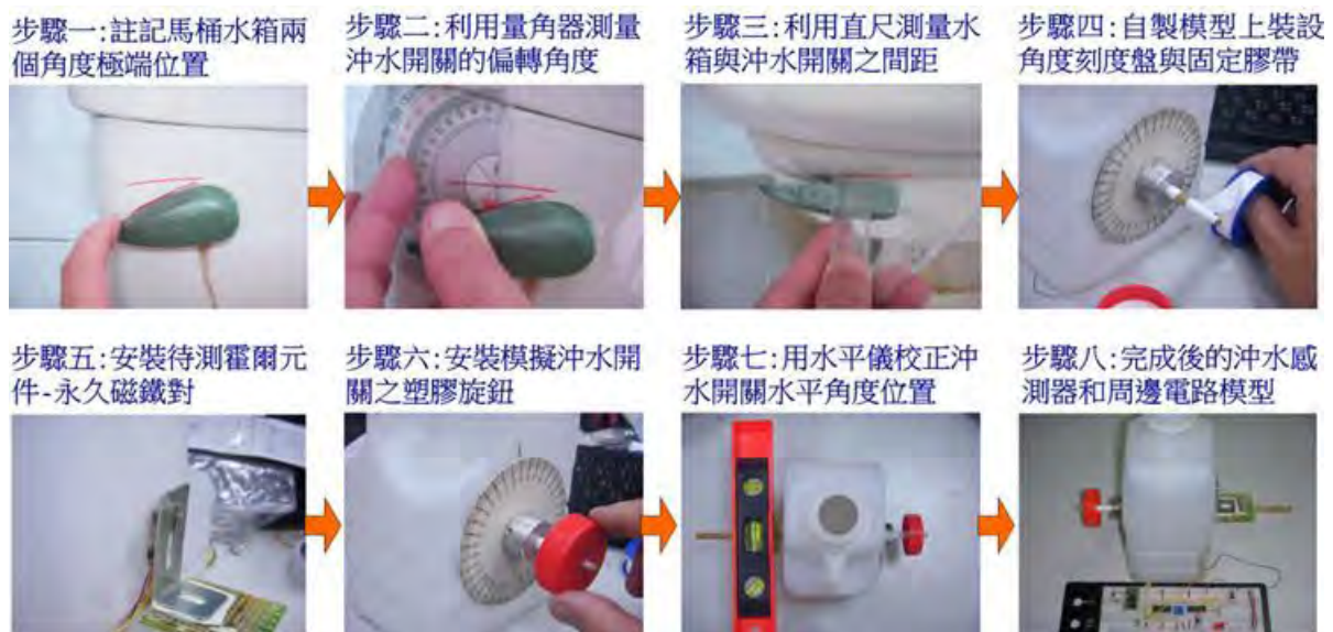
圖 10 (a)馬桶沖水感測器實驗模型的製作過程
