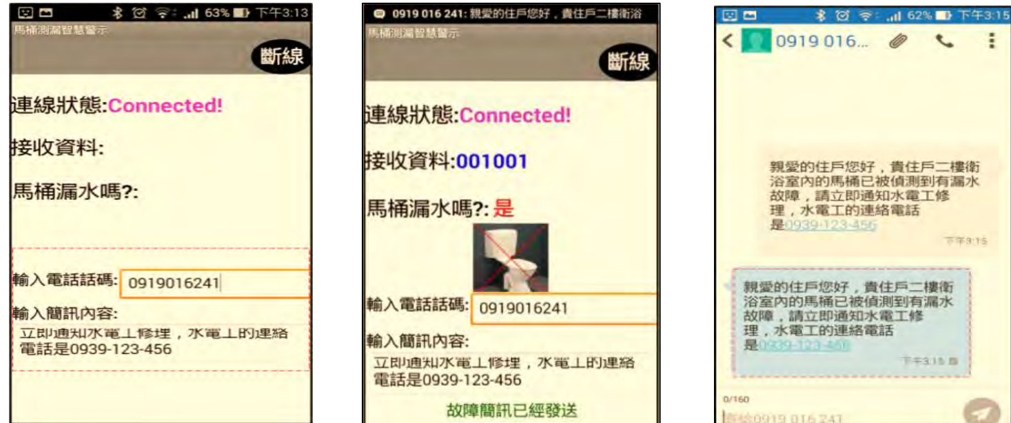
發生馬桶漏水故障時，顯示端智慧行動手機螢幕顯示的畫面內容
