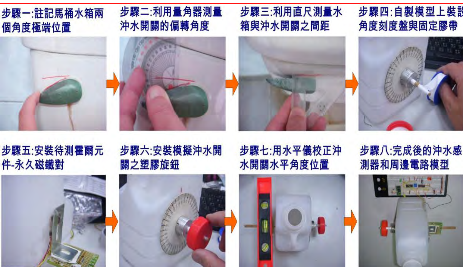
馬桶水箱沖水開關及其周邊機構的實驗模型製作過程
