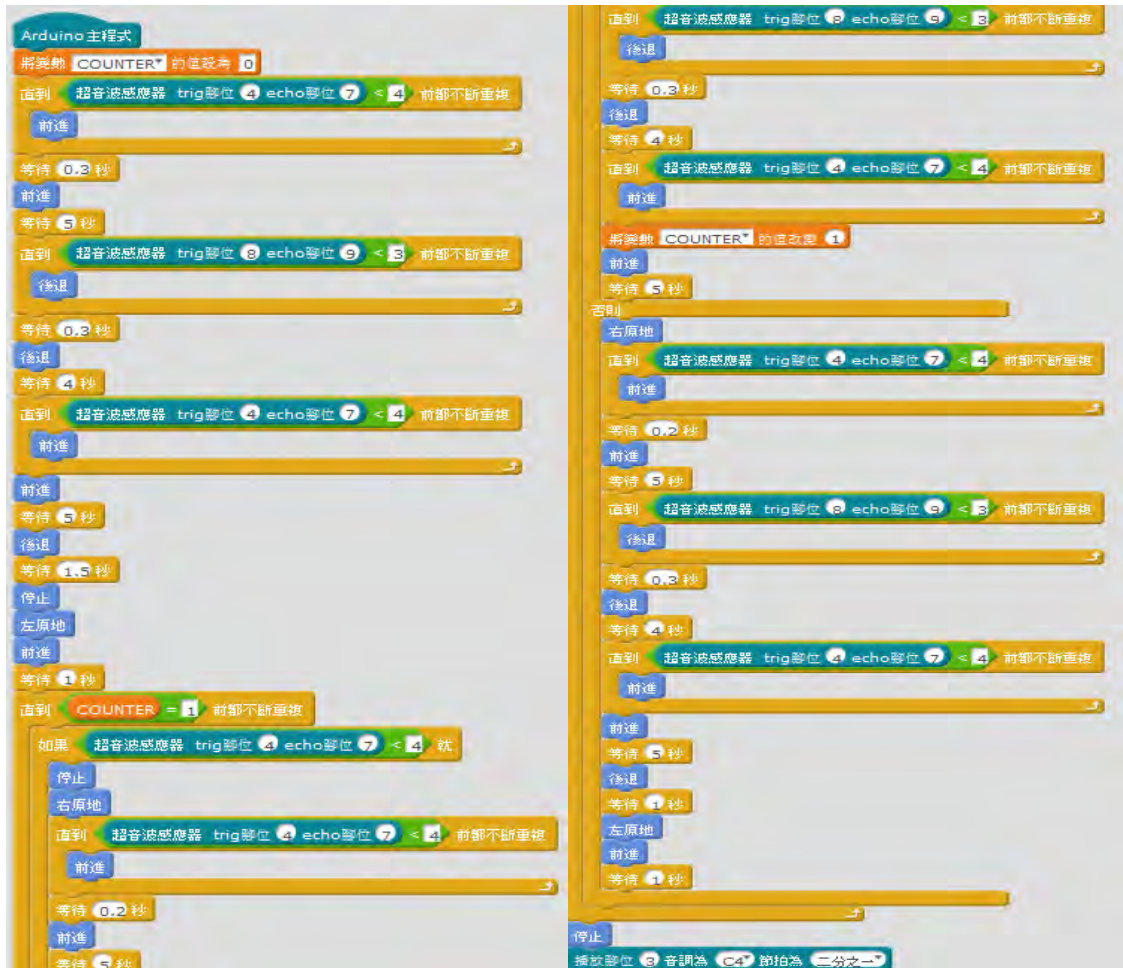
圖 6、擦窗戶機器人擦拭行徑程式。
