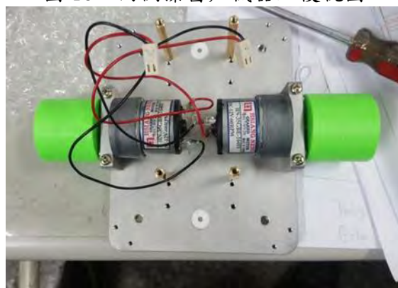
圖 17、內側擦窗戶機器人組裝情形
