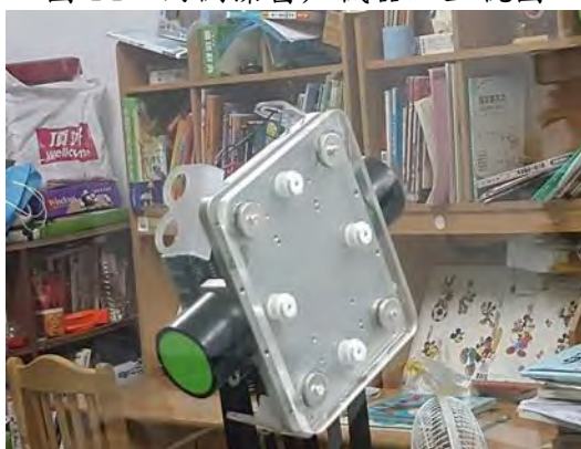
圖 16、擦窗戶機器人吸附至窗戶情形
