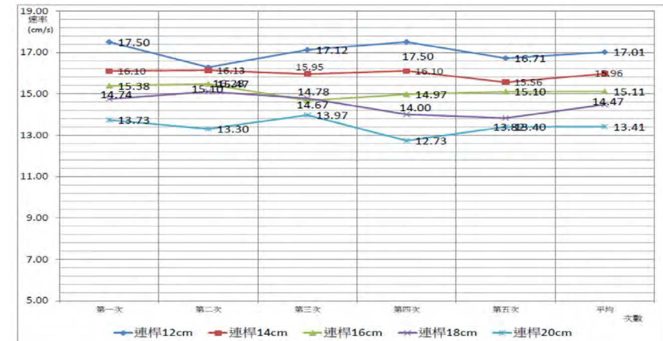
圖 6-18：身體配重為 4 個螺帽時，不同連桿長短對蟲蟲前進的速率影響
