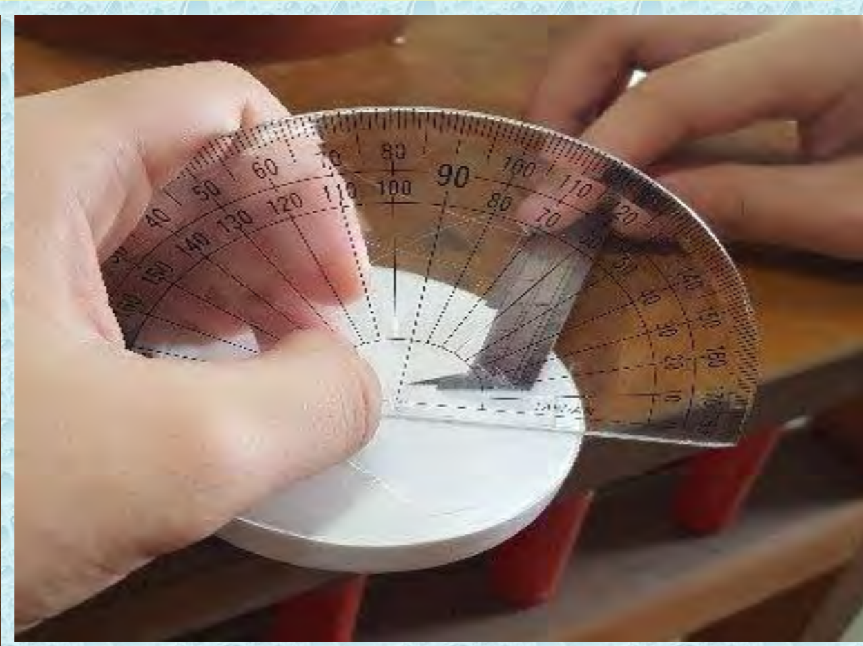
照片14： 利用量角器及鐵尺掀起扇葉角度
