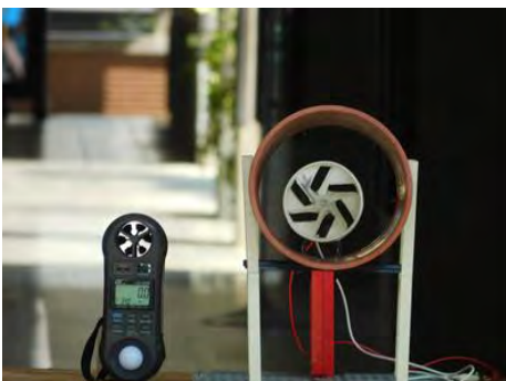
照片 15：測量川廊風速
