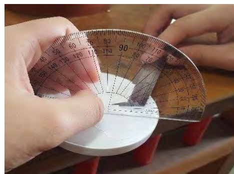
照片 14-2：利用量角器及鐵尺掀起扇葉角度
