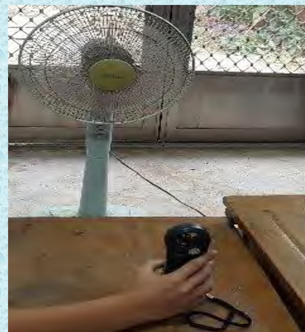
照片9： 電風扇的風速測定
