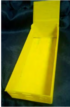
圖四：試驗渠道 3D 列印模型
