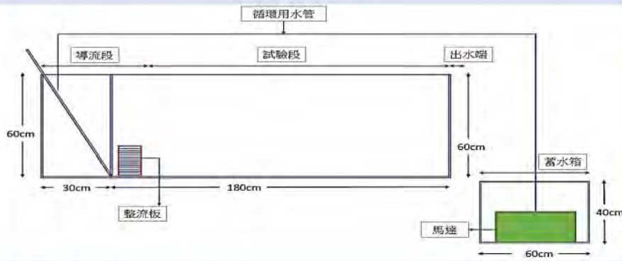
導流段： 渠道前端置入由吸管制成的整流板，以減少紊流及水面波動。
