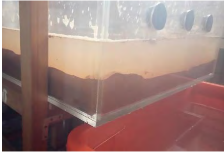
圖八：水道鋪設底土
