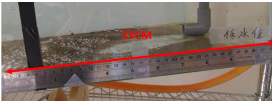
【圖 26】坡度 5 度時頂坡距水槽右側 33cm
