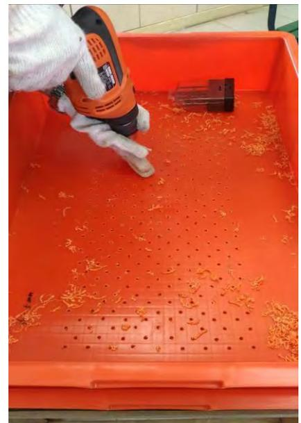
圖 7 落水盆孔徑 5mm 製作過程
