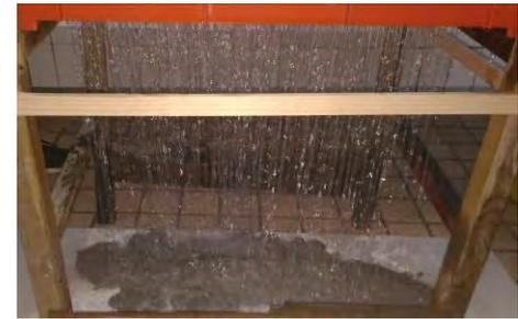
圖 13 落水孔 5mm 降雨水深 14cm
