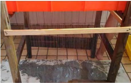
圖 11 落水孔 1.5mm 降雨水深 14cm
