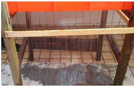
圖 9 落水孔 3mm 降雨水深 7cm
