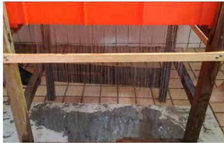
圖 12 落水孔 3mm 降雨水深 14cm
