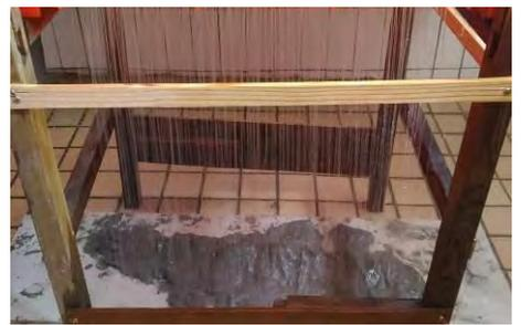
圖 10 落水孔 5mm 降雨水深 7cm
