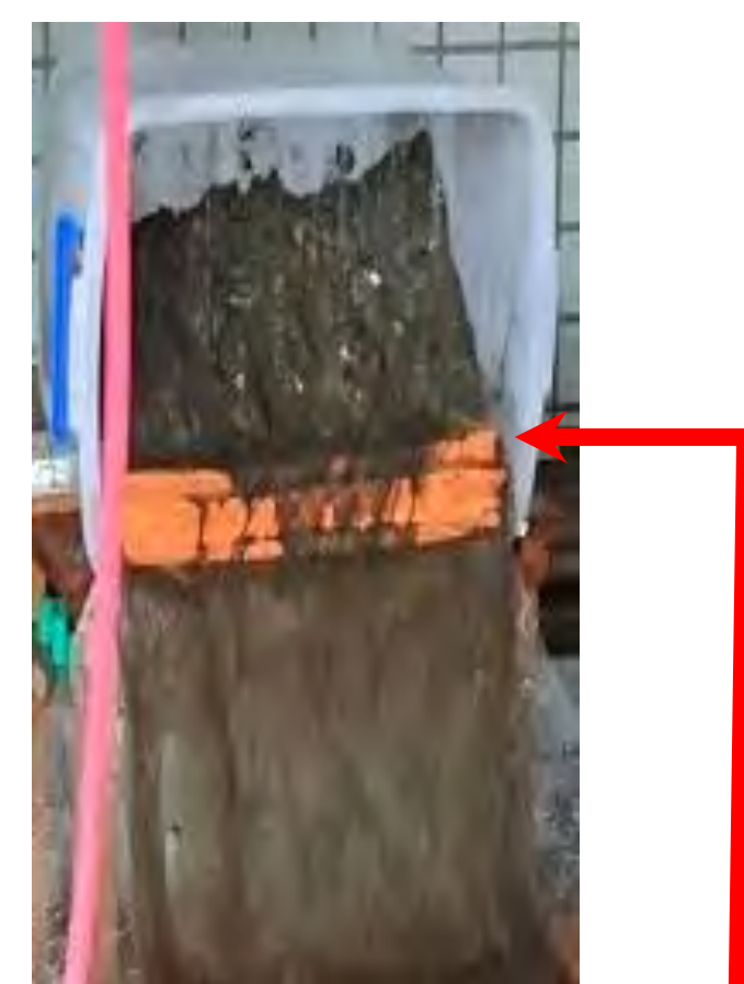
圖 40 內外牆間距可容納崩塌土石
