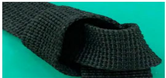
圖 5-14 扁平繩在纏繞處的立體結構
