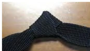
圖 6-1 扁平繩單結拉緊後纏繞處的變形
