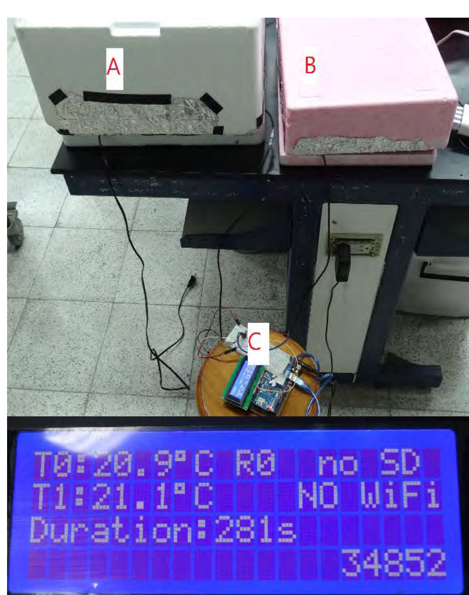
圖4.3、溫度控制設備，若溫度不同時，開啟加熱板，使兩邊溫度相同。
