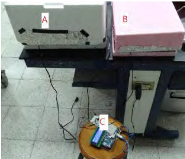
圖 4.9、整體環境配置，A. 無 Wifi 環境、B. 有 Wifi 環境、C. 溫度監控設備。
