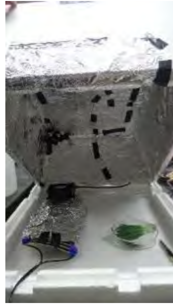
圖 4.8、無照射 Wifi 環境，使用保麗龍箱，並用鋁箔包覆內壁，保持溫度恆定及防止電磁波外溢。
