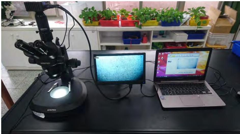
圖五、左邊為三目解剖顯微鏡，中間為觀測 LCD，將觀測過程的影像輸入到最右邊的筆電，之後再以圖像分析軟體 tracker 進行心臟收縮與舒張時的內徑變化計算。
