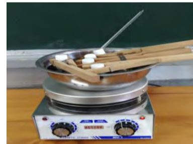
圖六 以加熱攪拌器隔水加熱
