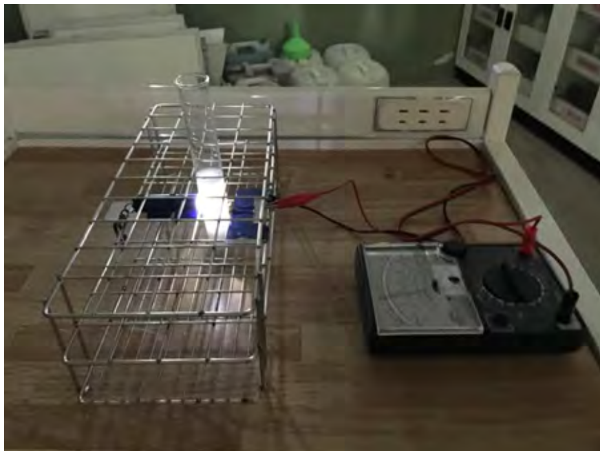
儀器圖示：光敏電阻觀測組
