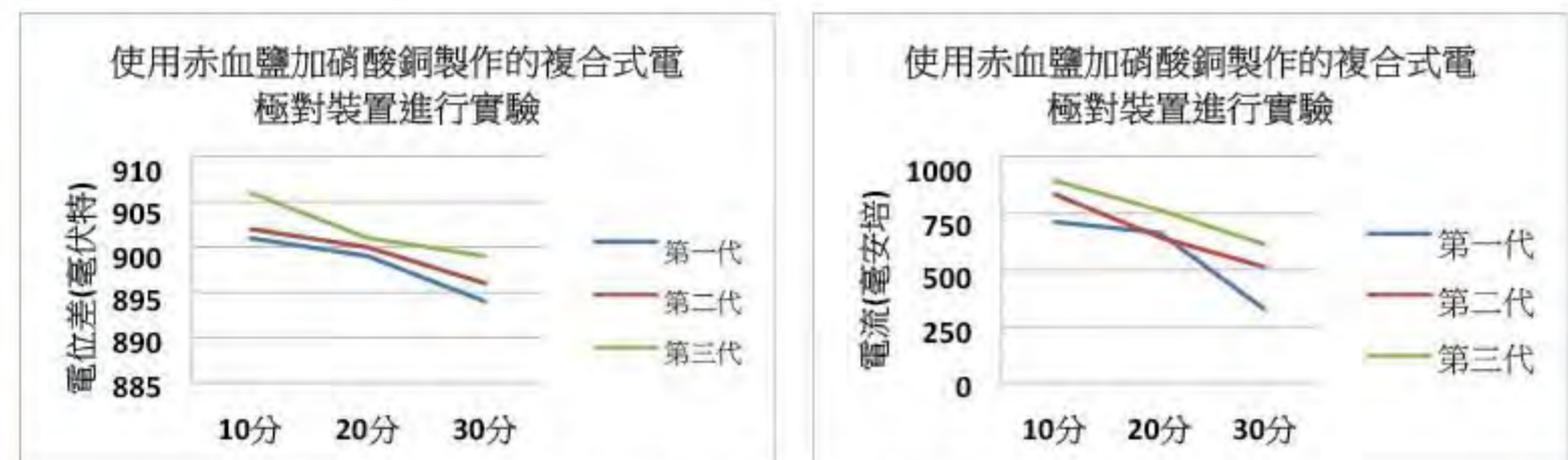
圖 43、使用赤血鹽加硝酸銅製作的複合式電極對裝置進行實驗
