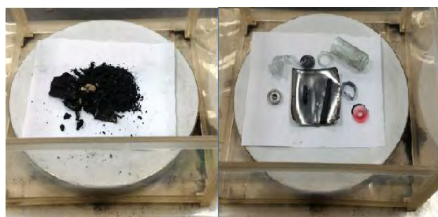
圖一:拆卸廢電池的內容物，左為乾電池粉末，右為鋅殼、碳棒與包裝
