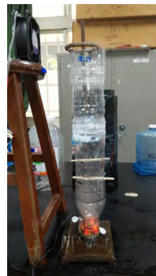
圖九 噴濺高度對明膠粒徑影響實驗裝置
