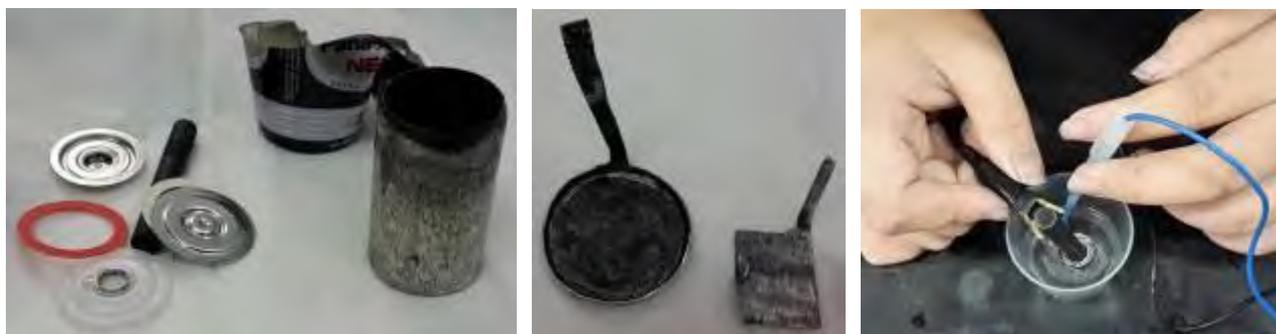
圖 27 乾電池拆解圖
