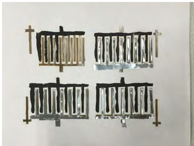
圖十、不同電極間距的薄膜電池
