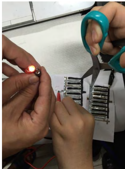
圖三十一、串聯兩組鋅膠帶負極電池驅動一 LED 燈泡。
