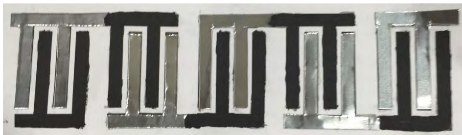
圖二十三、已完成之使用鋅膠帶為電極之電池
