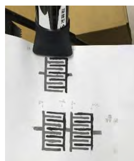
圖三、使用吹風機吹乾電極
