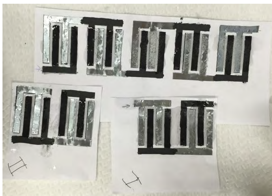
圖二十一、塗上電解液之使用鋅膠帶為電極之電池
