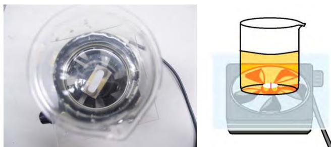
圖 5-5 攪拌機儀器完成圖及示意圖
