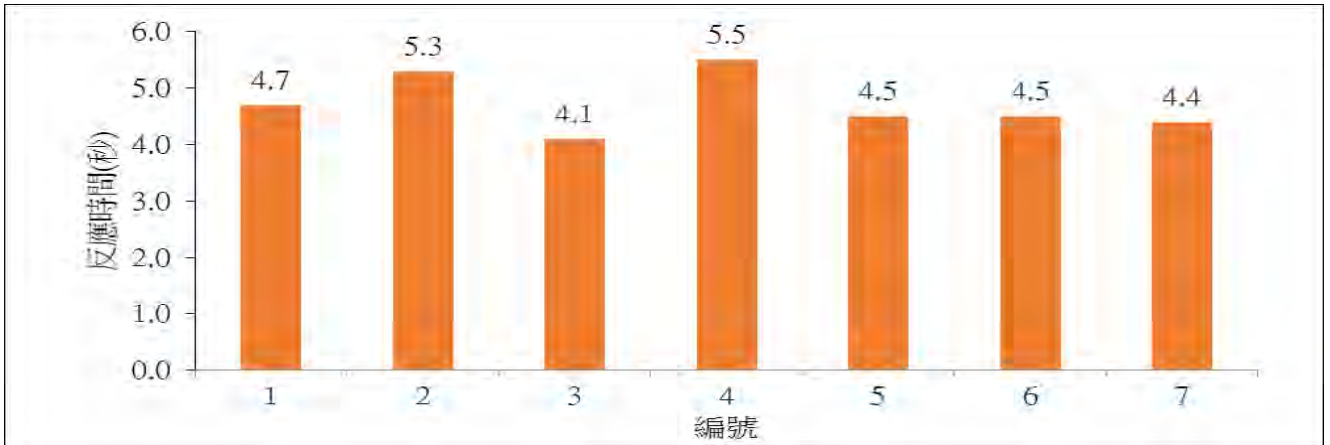
圖五 氯化亞鐵當催化劑分解 28%雙氧水產生氧氣充滿廣口瓶所需時間
