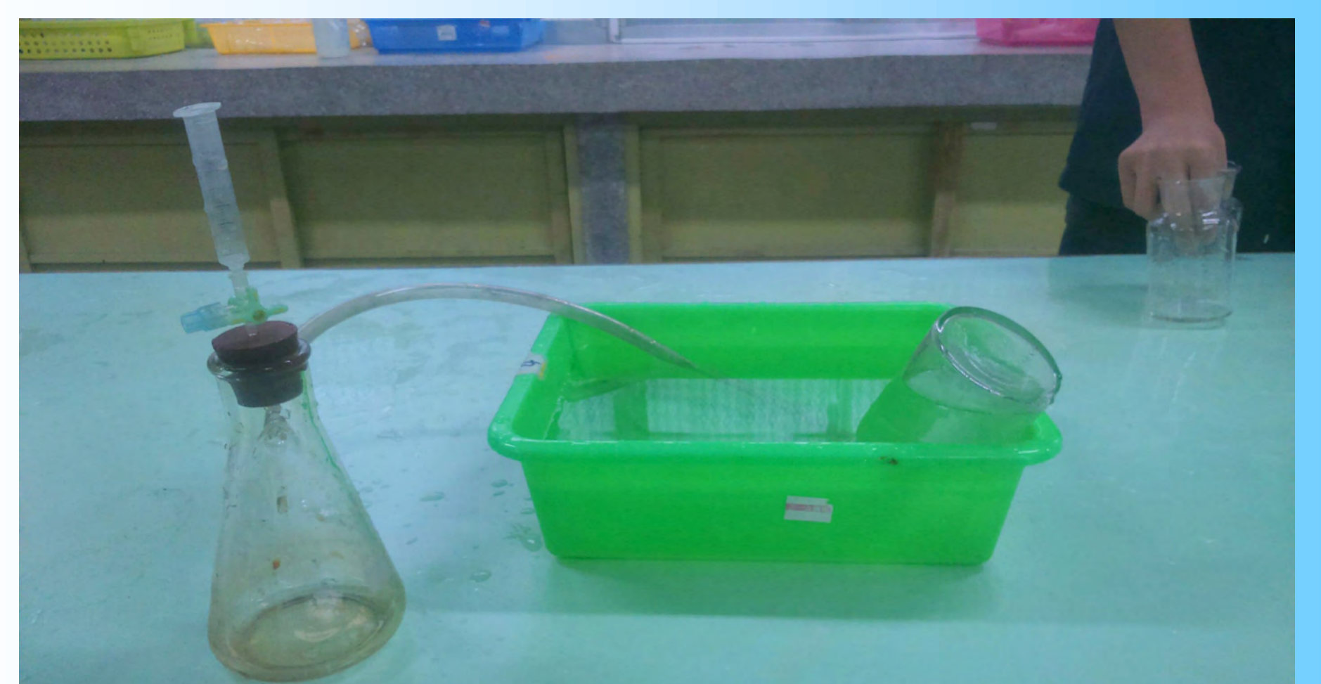
【圖二 改良後的雙氧水分解實驗裝置圖】
