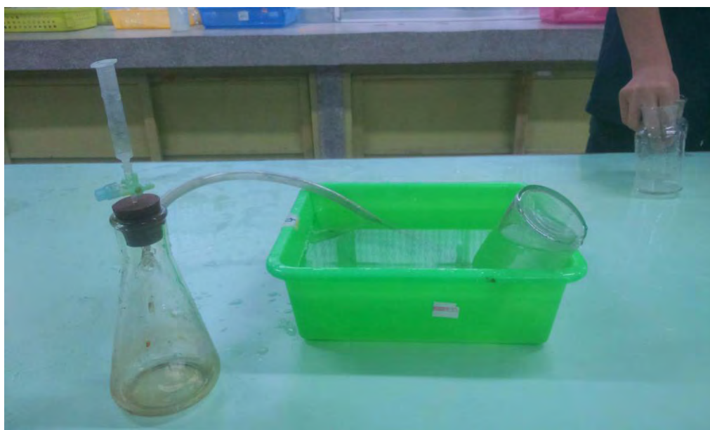
圖二 改良後的雙氧水分解實驗裝置圖
