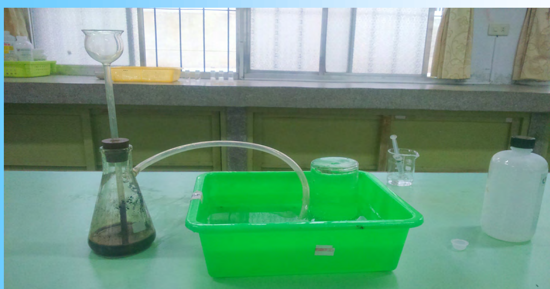
【圖一 雙氧水分解原有的實驗裝置圖】
