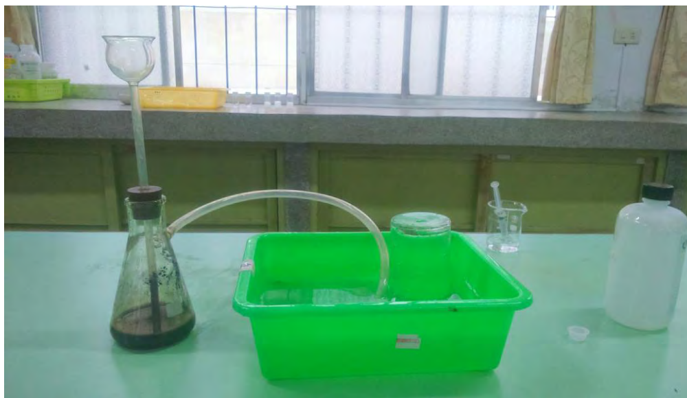
圖一 雙氧水分解原有的實驗裝置圖
