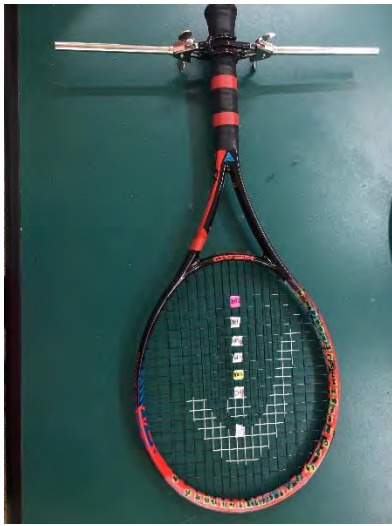
圖 7-10 以兩支三叉夾夾住球拍的握位處，置於鐵架上進行小角度的擺盪，紀錄 5 次震盪時間，取得震盪週期(T)
