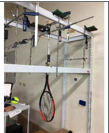
圖 5-3 球以模擬單擺方式，撞擊拍面上的指定位置。
