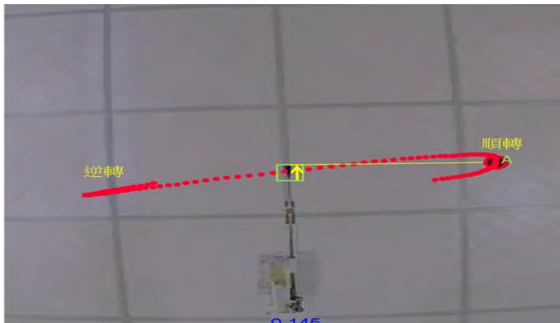
圖 52 當推桿至往前的最後端，而後開始 往前拉動 擺錘形成由 逆轉順 。
