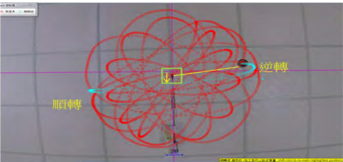
圖 46 當推桿至往前的最前端，而後開始往後拉動擺錘形成由順轉逆。
